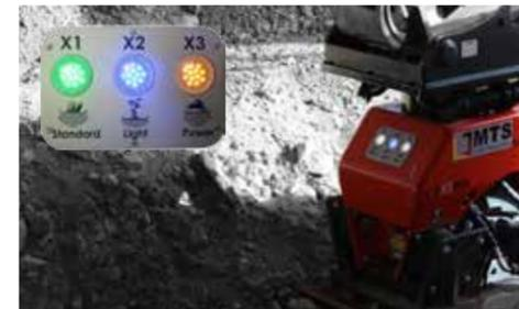
ALLE LEDs blinken, wenn das Ende der Verdichtung erreicht ist.
