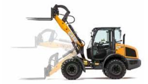
Z-Kinematik ist die vielseitigste Hubgeometrie. Sie bietet höhere Ausbrechkräfte aufgrund der 2 Hubzylinder und eine größere Ausschütthöhe.
